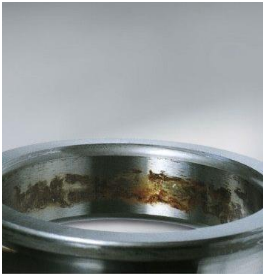
Figure 12 Cavités et rouille sur le chemin externe du roulement
