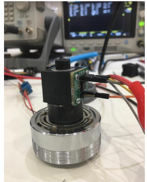
Figure 120 Test du capteur ADXL 356 sur le shaker
