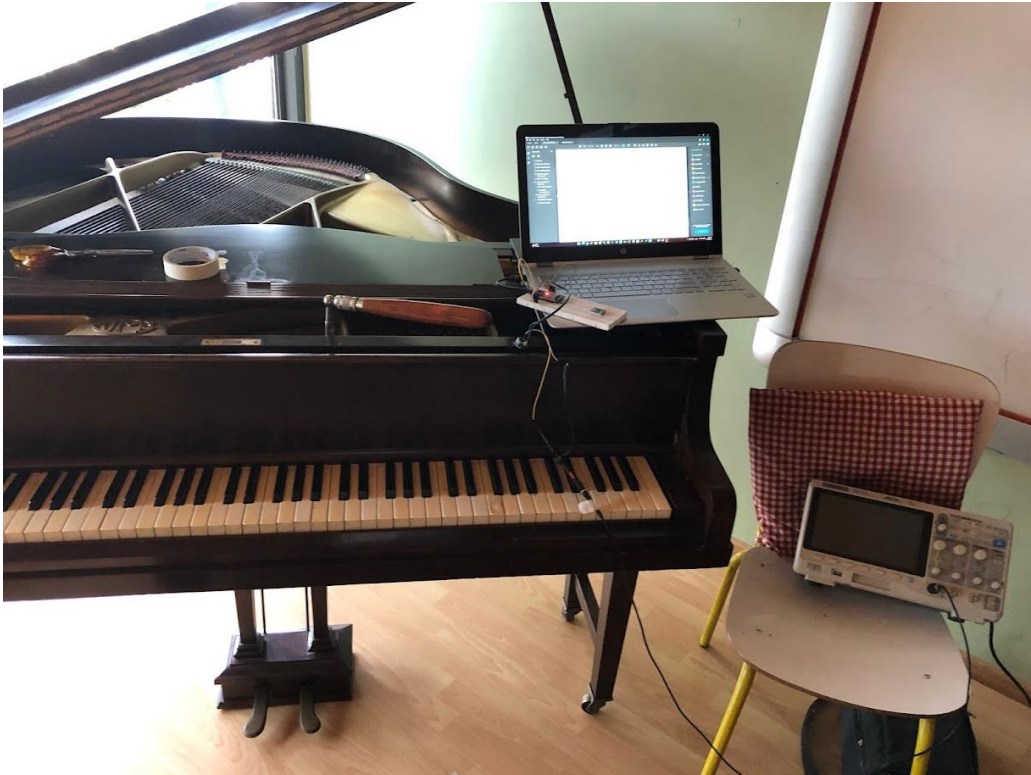
Figure 156 Acquisition de signaux vibratoire d'un piano
