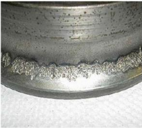
Figure 11 Cavités sur le chemin intérieur du roulement
