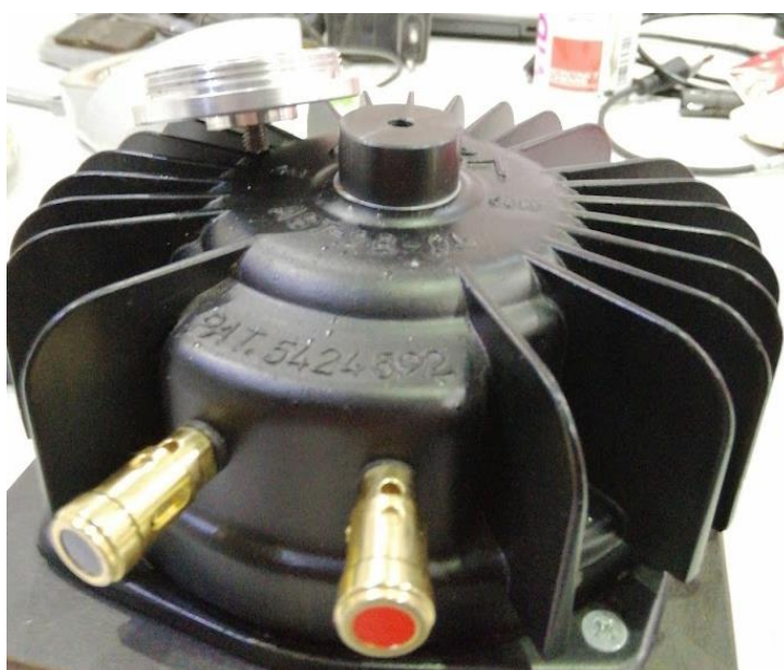
Figure 103 Shaker de 100 W pour les tests à basse fréquence
