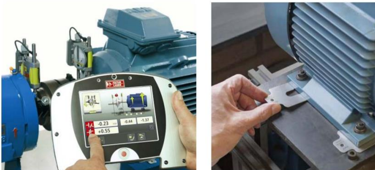
Figure 6 Défaut de désalignement
