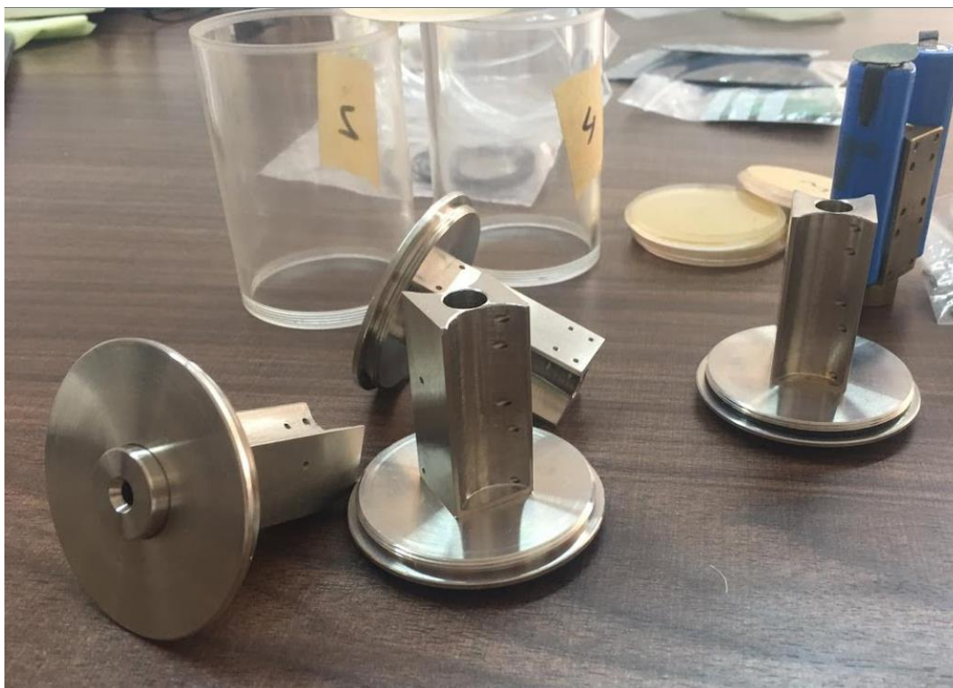
Figure 99 Chassie et Boitiers du version 3 du capteur. Fabriquées sur une machine à tour
