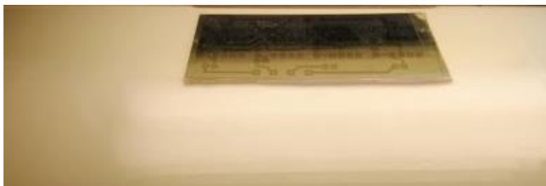
Figure 77 Exposition du PCB à la lumière UV
