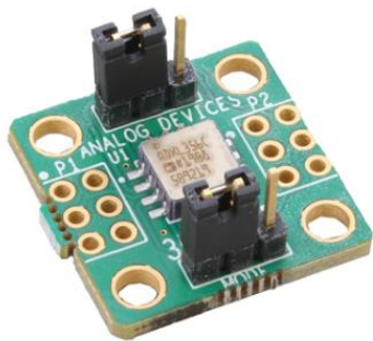
Figure 25 Accéléromètre ADXL 356C de type MEMS
