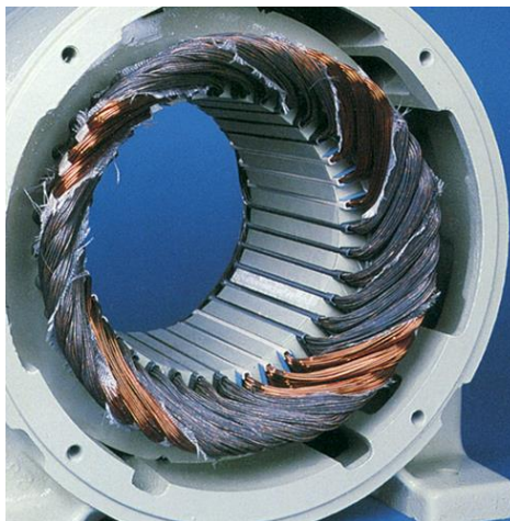
Figure 8 Défaut de faute d'isolement
